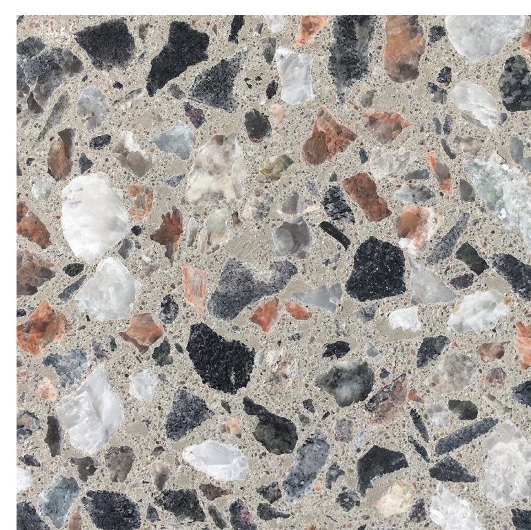
Golv i entréhall, korridor för konst och hisshall Platsgjuten cementmosaik special kulör
